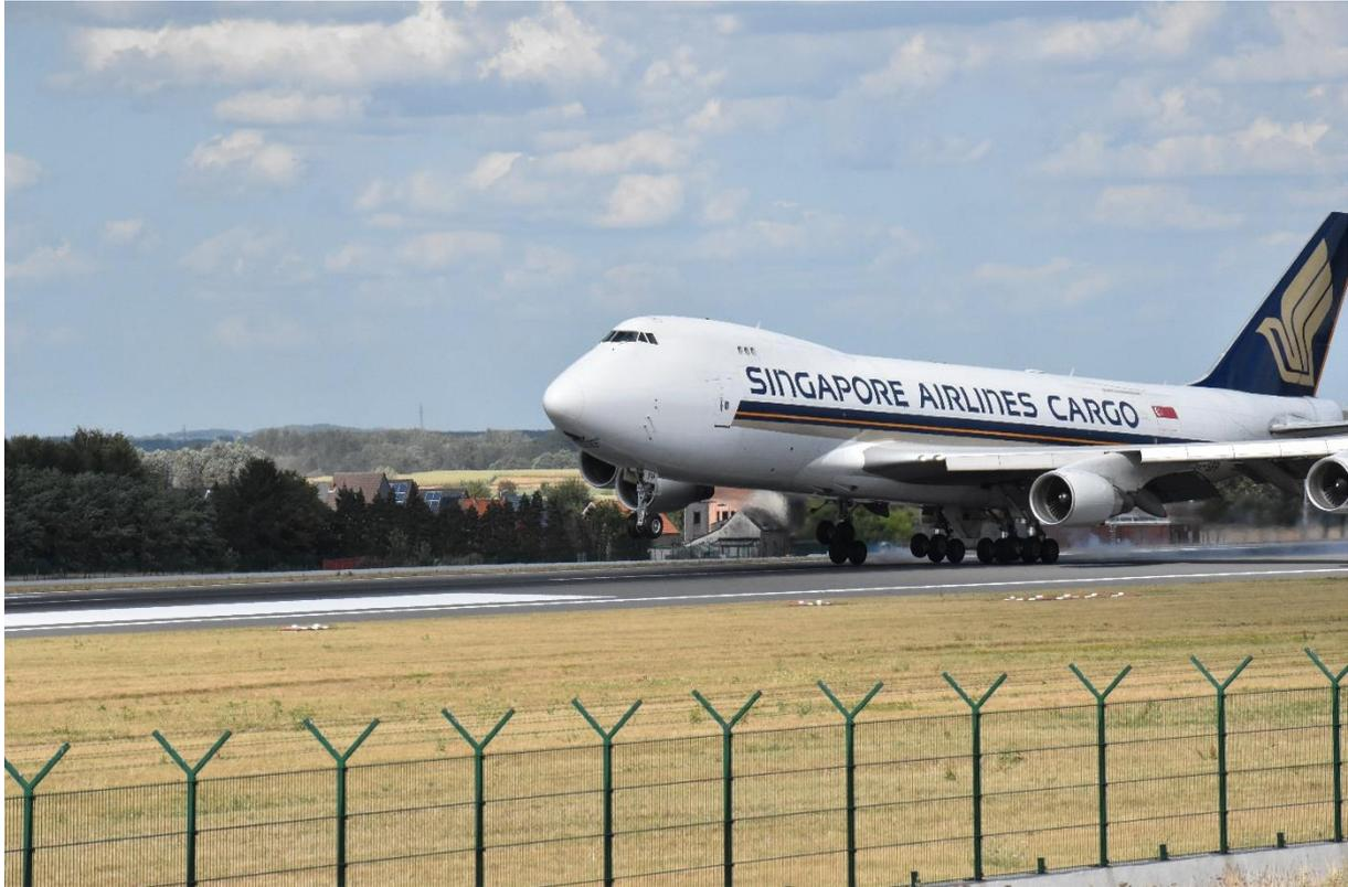
Ce quadri-réacteur d'un MTOW de 395 tonnes dispose d'un QC au décollage de 18.6 (SINGAPORE), 24.0 (SINGAPORE) ou de 24.8 (KALITA), et reste un avion très bruyant qui monte plus lentement et donc prend moins vite l'altitude requise pour entamer sa manœuvre de virage en piste 19 à 700 ou 1.700 pieds :
