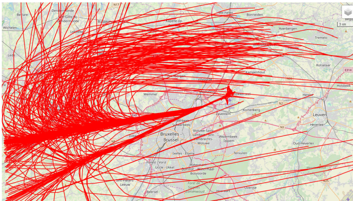
Tracés radar des 331 atterrissages 07L du 16 août 2016 (RNP ligne droite et VOR approche courbe)
